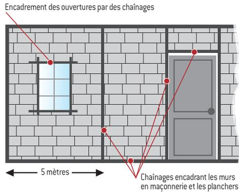
Figure 13. Ajout de chaînages horizontaux et verticaux encadrant les maçonneries (élévation)
