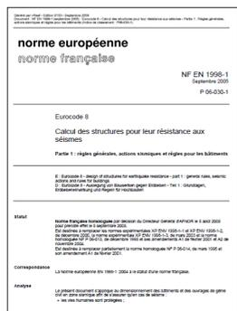
**Réglementation sur les bâtiments neufs.** L'Eurocode 8 s'impose comme la règle de construction parasismique de référence pour les bâtiments. La réglementation conserve la possibilité de recourir à des règles forfaitaires dans le cas de certaines structures simples.
