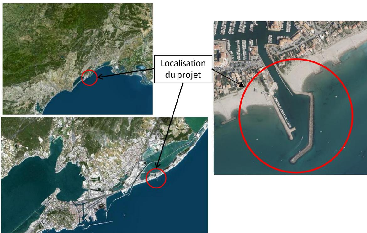
Le projet vise à **rétablir la circulation des navires dans la passe d'entrée du port de plaisance de Frontignan** dû à l'ensablement naturel. Dans l'avant-port une cote de -3m CM (Cote Marine) est préconisée. Au niveau de la zone extérieure ouest de la digue, la cote de projet est de -2,5 m CM.
