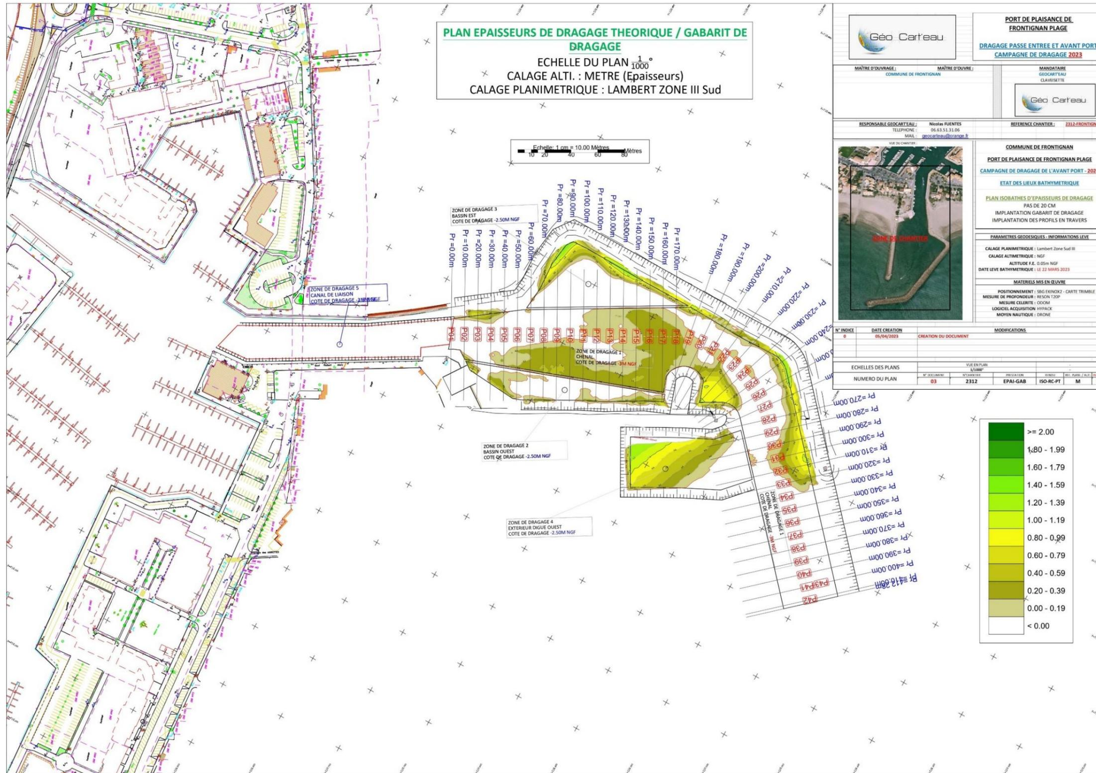
Figure 7 : Plan d'épaisseur de dragage d'avril 2023 (Source :Géo cart'eau)
