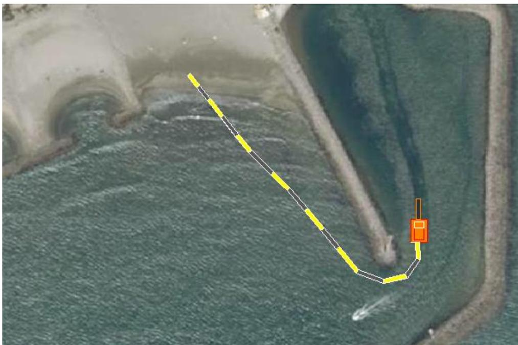
Figure 9 : Dragage hydraulique et refoulement vers les plages
