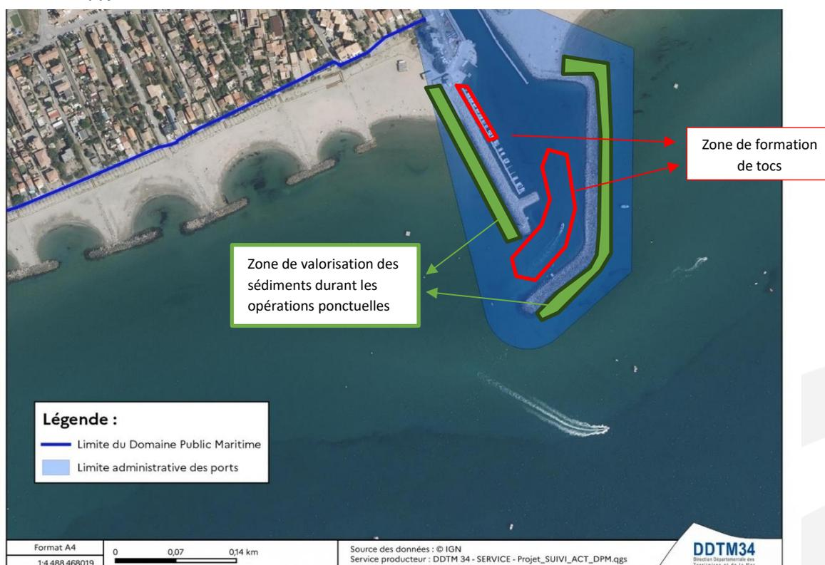
Figure 10 : Localisation de la zone de valorisation des sédiments pour les opérations ponctuelles
