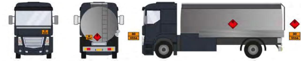
Si le véhicule transporte plusieurs matières, les plaques orange sont, apposées respectivement sur les côtés du véhicule (à chaque section correspondante). Le symbole de danger doit être fixé à l'arrière et sur la cuve contenant la matière. Ceci est semblable lors du transport de citerne ferroviaire.
